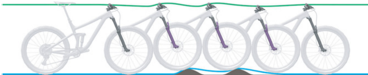
Rysunek 72: Zbyt wolne rozprężanie widełca amortyzowanego
