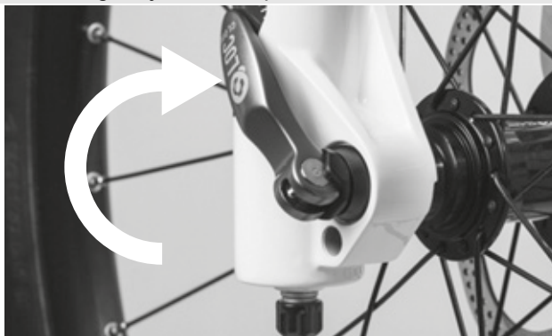
Rysunek 32: Zamykanie zacisku szybko mocującego
