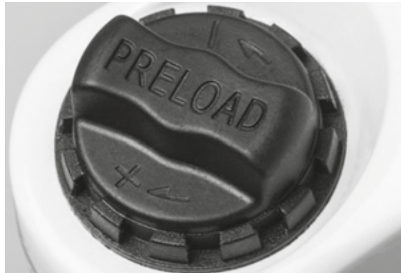
Rysunek 40: Pokrętko regulacyjne parametru SAG usytuowane na koronie widelca amortyzowanego
