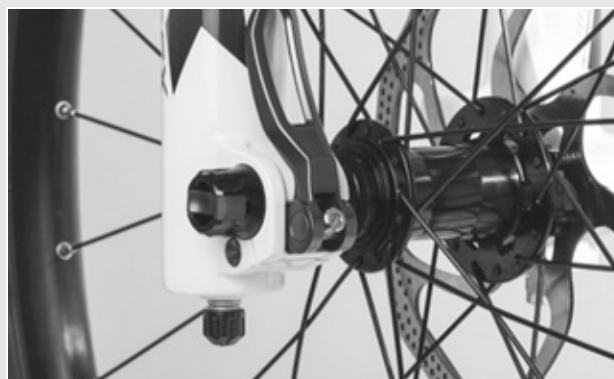
Rysunek 65: Ustawianie siły mocowania zacisku szybkomocującego
