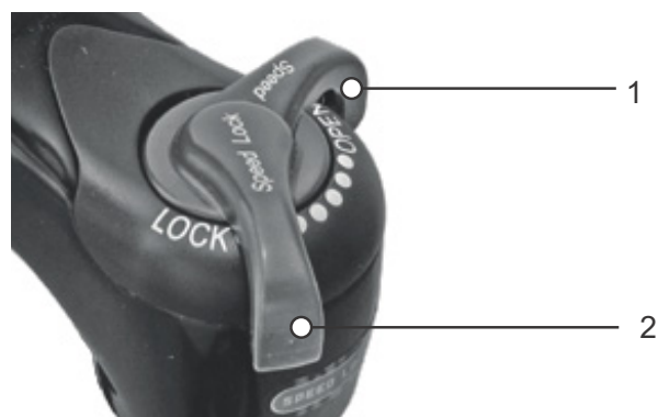
Rysunek 62: Tłumik dobicia Suntour w otwartej (1) i zamkniętej (2) pozycji.
