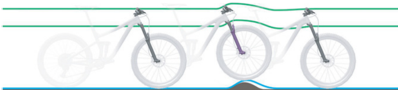
Rysunek 76: Zbyt twarde tłumienie widełca amortyzowanego na nierównościach
