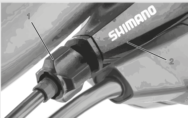
Rysunek 67: Nakrętka regulacyjna (1) jednoczęściowego mechanizmu zmiany przerzutek z obudową dźwigni zmiany biegów (2), przykład
