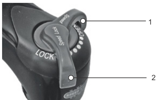
Rysunek 75: Tłumik dobicia Suntour w otwartej (1) i zamkniętej (2) pozycji.
