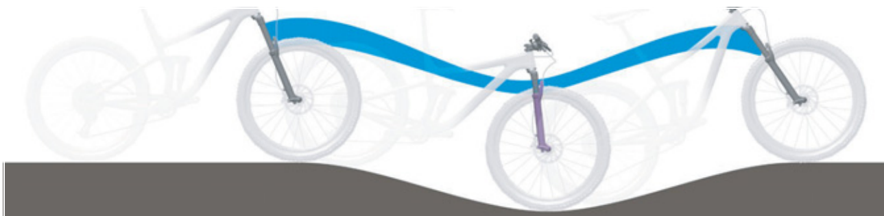
Rysunek 74: Zbyt miękkie amortyzowanie widelca na wzniesieniu
