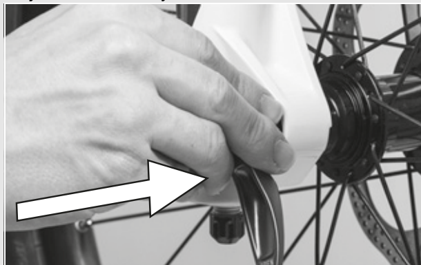
Rysunek 30: Wsuwanie zacisku szybko mocującego
