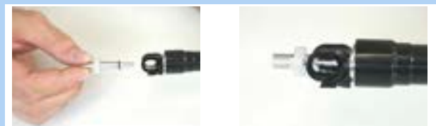
Rysunek 264: Wkręcanie adaptera zaworu
