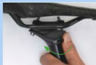
Rysunek 303: Zamykanie mechanizmu regulacji wysokości
