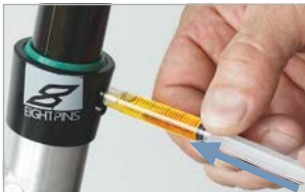
Rysunek 212: Smarowanie sztycy podsiodłowej EIGHTPINS
