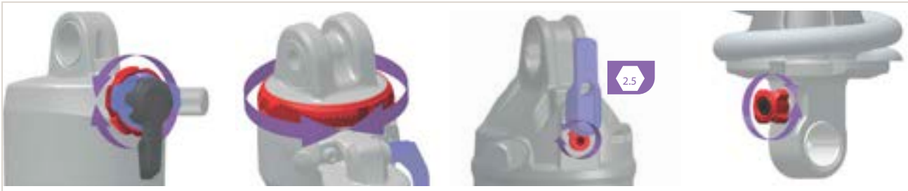
Rysunek 177: Pozycja i kształt nastawnika odbicia (tylnego amortyzatora) zależą od modelu. Nastawniki odbicia są zawsze koloru czerwonego
