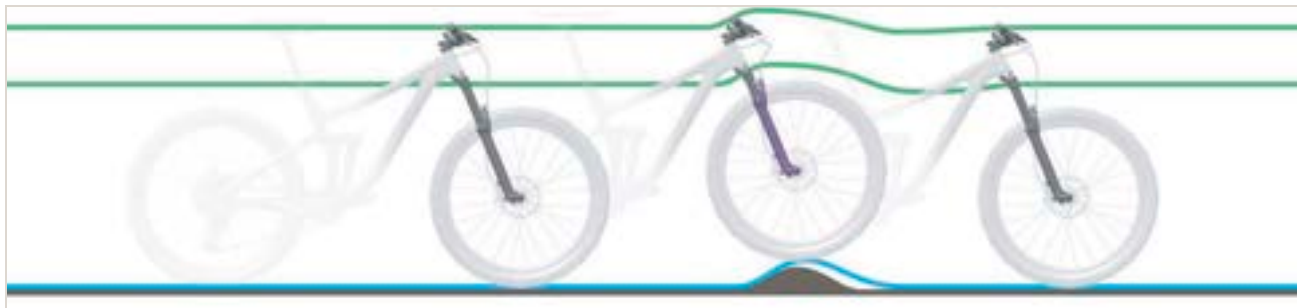
Rysunek 316: Zbyt twarde tłumienie widelca amortyzowanego na nierównościach
