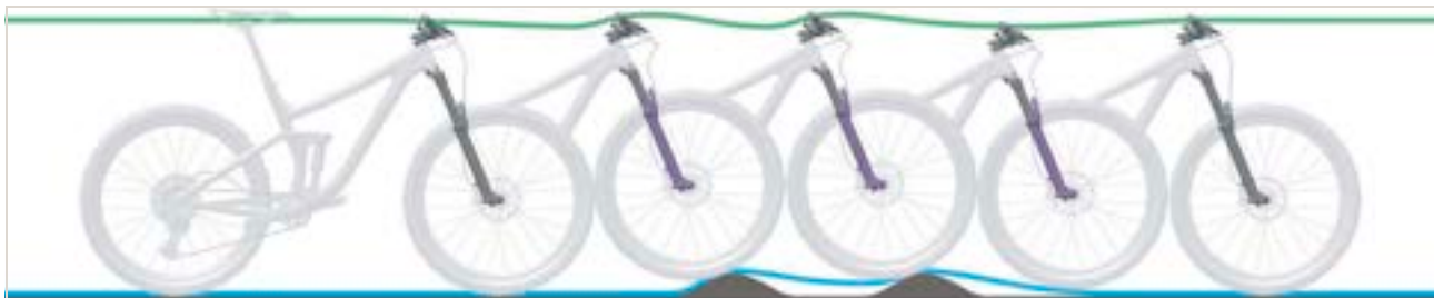
Rysunek 312: Zbyt wolne rozprężanie widelca amortyzowanego
