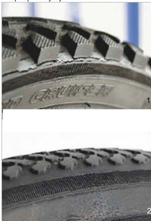
Rysunek 215: Przykłady pęknięć zmęczeniowych (1) i w wyniku starzenia się (2)
