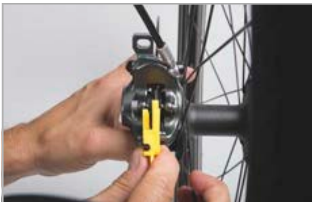
Rysunek 216: Sprawdzenie stanu klocków hamulca w stanie zamontowanym za pomocą zabezpieczenia transportowego
