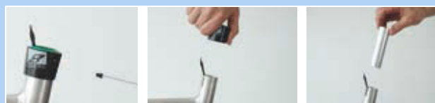
Rysunek 289: Demontaż tulei zewnętrznej i tulei ślizgowej
