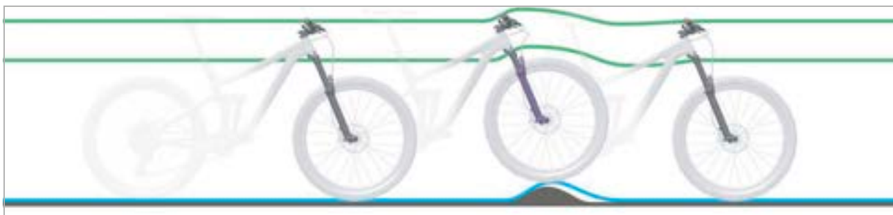
Rysunek 323: Zbyt twarde tłumienie widelca amortyzowanego na nierównościach
