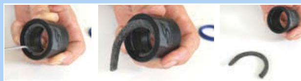
Rysunek 258: Wyciąganie pierścienia filcowego
