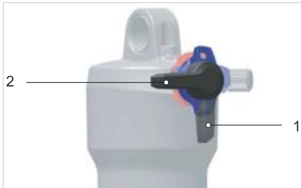
Rysunek 186: Pozycja otwarta (1) i pozycja progowa (2) w tylnym amortyzatorze (kolor czarny)
