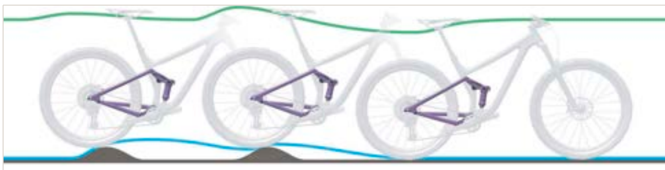
Rysunek 326: Zbyt wolne rozprężanie się tylnego amortyzatora
