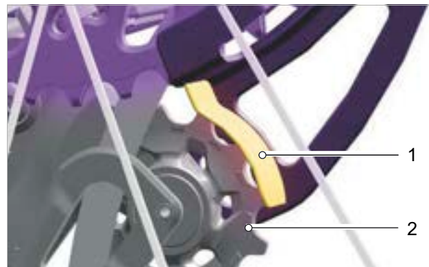
Rysunek 156: Płetwa (1) dotyka górnego kółka (2)
