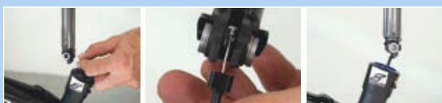
Rysunek 305: Zaczepianie i wsuwanie sztycy podsiodłowej
