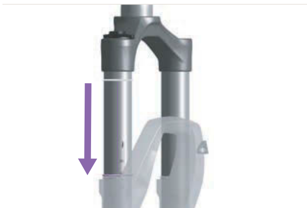
Rysunek 169: Przesuwanie pierścienia o-ring widelca amortyzowanego
