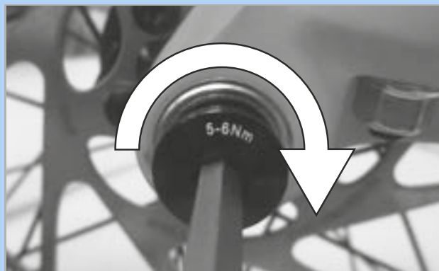
Rysunek 92: Sposób dokręcania śruby zabezpieczającej
