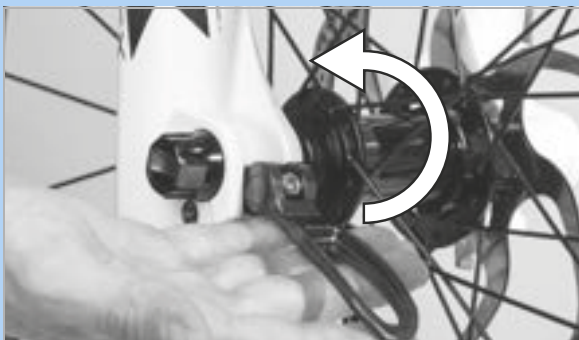
Rysunek 96: Docisnąć dźwignia zacisku szybko mocującego zgodnie z kierunkiem strzałki
