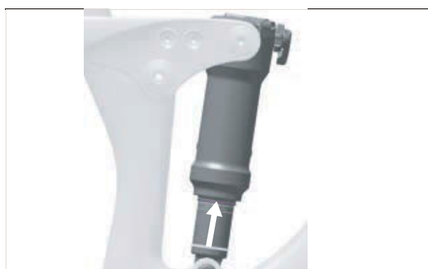
Rysunek 173: Przesuwanie pierścienia o-ring na tylnym amortyzatorze
