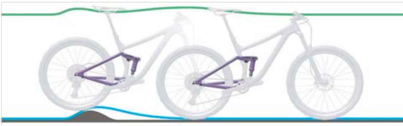
Rysunek 330: Zbyt twarde tłumienie tylnego amortyzatora na nierównościach
