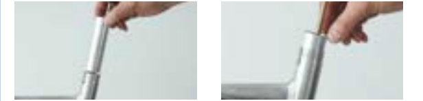
Rysunek 278: Wsuwanie tulei ślizgowej w rurę siodełka
