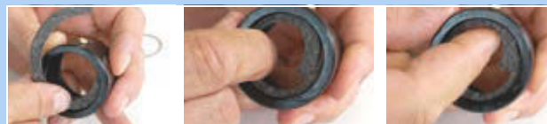
Rysunek 295: Wkładanie pierścienia filcowego
