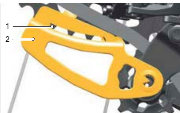
Rysunek 155: Wycięte okienko (1) z zębami na przymiarze do regulacji przerzutki (2)
