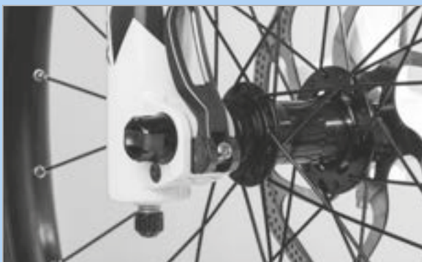
Rysunek 97: Optymalne położenie dźwigni mocującej
