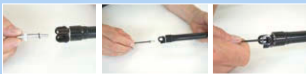
Rysunek 266: Mocowanie nakrętki zaworu wkładu
