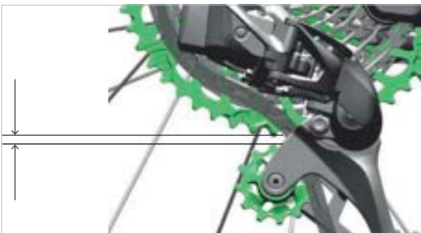
Rysunek 160: 3 mm odległość między kółkiem a zębami
