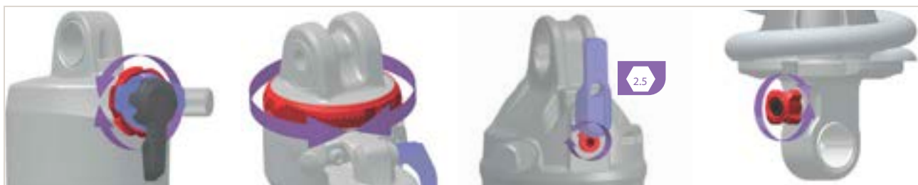
Rysunek 327: Pozycja i kształt nastawnika odbicia (kolor czerwony) zależy od modelu
