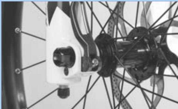
Rysunek 244: Ustawianie siły mocowania zacisku szybko mocującego
