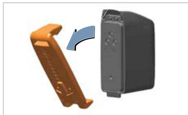
Rysunek 348: Zdejmowanie osłony akumulatora
