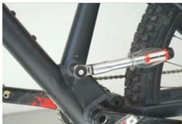
Rysunek 118: Dociąganie osi sztycy podsiodłowej
