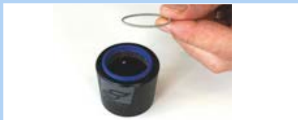
Rysunek 256: Wyciągnięty pierścień sprężysty
