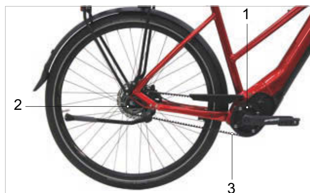
Rysunek 51: Schemat napędu paskowego
