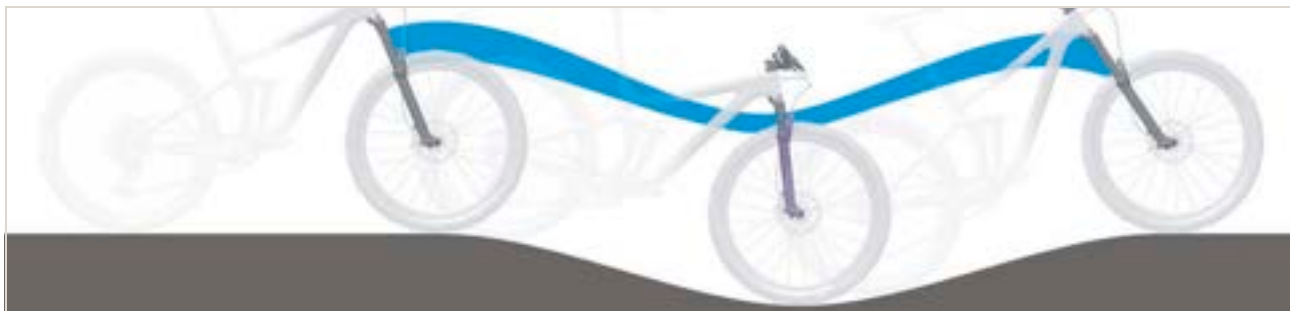
Rysunek 314: Zbyt miękkie amortyzowanie widelca na wzniesieniu
