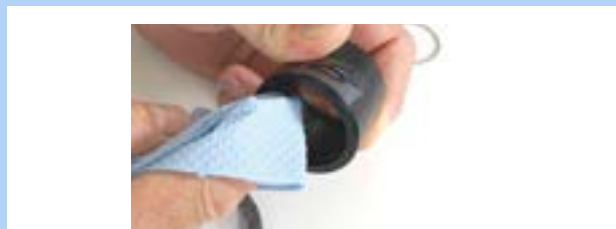
Rysunek 259: Czyszczenie tulei zewnętrznej
