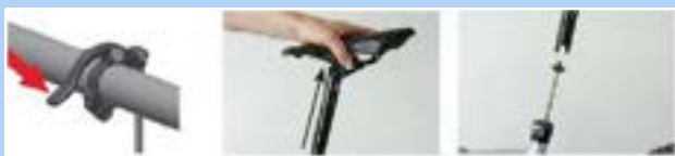
Rysunek 248: Wyciąganie sztycy podsiodłowej
