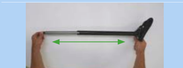
Rysunek 299: Rozsuwanie sztycy podsiodłowej
