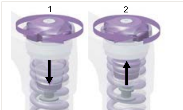
Rysunek 168: Dokręcanie (1) i odkręcanie (2) pokrętła regulacyjnego SAG
