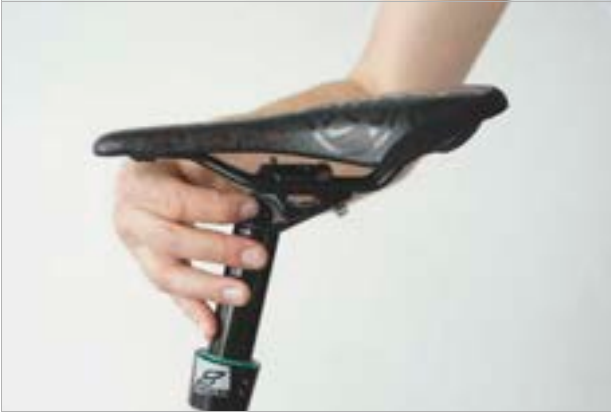
Rysunek 133: Ustawianie kąta siodełka za pomocą pokrętła regulacyjnego
