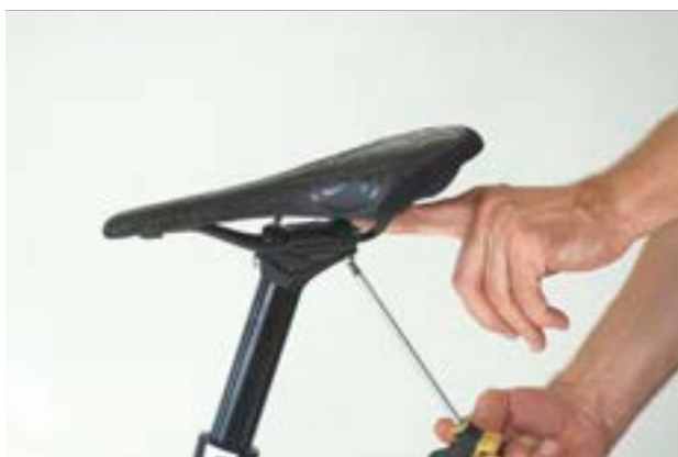
Rysunek 127: Odkręcanie tylnej śruby
