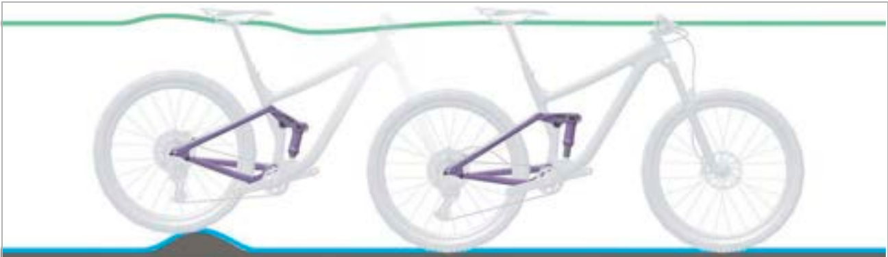
Rysunek 188: Optymalne działanie tylnego amortyzatora na nierównościach
