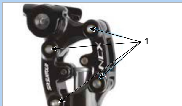
Rysunek 246: Punkty smarowania amortyzowanej sztycy podsiodłowej SR SUNTOUR
