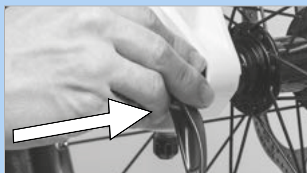
Rysunek 100: Wcisnąć zacisk szybkomocujący zgodnie z kierunkiem strzałki
