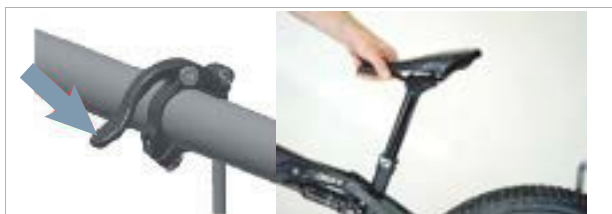
Rysunek 122: Wysuwanie hydraulicznej sprężyny gazowej
