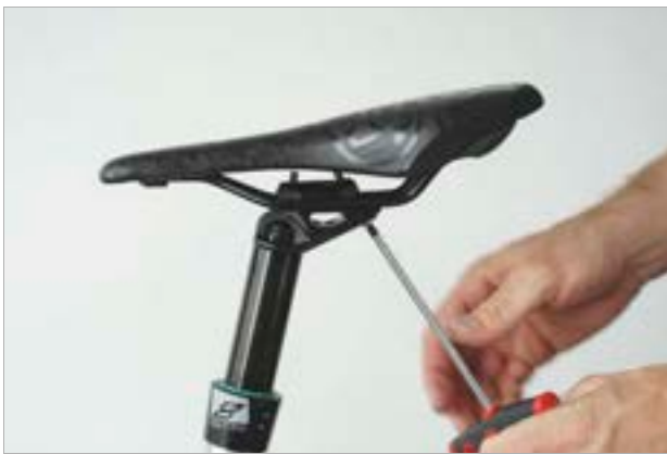
Rysunek 130: Odkręcanie tylnej śruby
