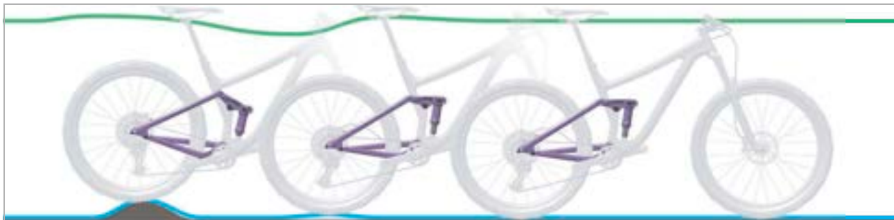
Rysunek 332: Zbyt szybkie rozprężanie się tylnego amortyzatora
