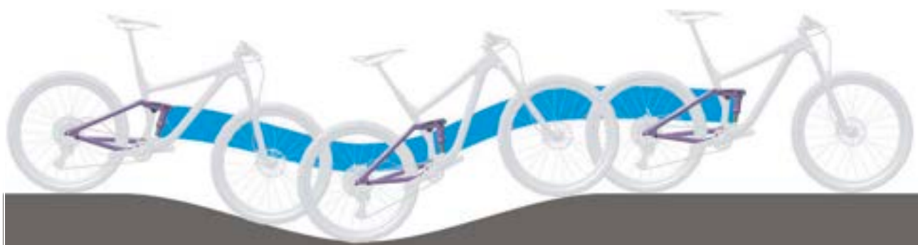
Rysunek 9: Optymalne działanie tylnego amortyzatora na pagórkowatym terenie
