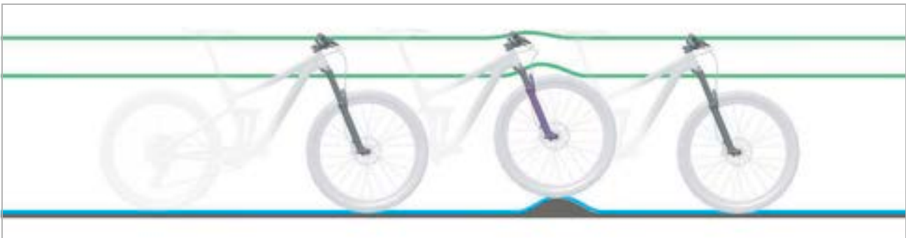
Rysunek 205: Twarde i miękkie ustawienie tłumika dobicia
