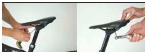
Rysunek 129: Mocowanie przedniej i tylnej śruby
