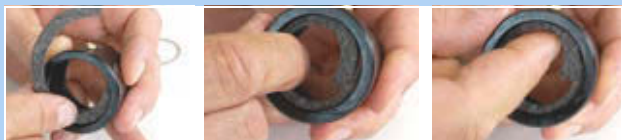
Rysunek 260: Wkładanie pierścienia filcowego
