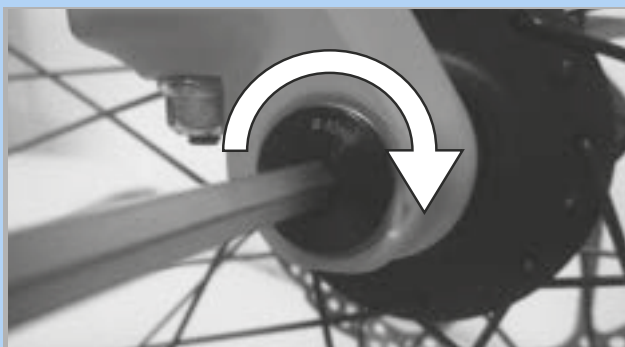
Rysunek 90: Dokręcić oś zgodnie z kierunkiem strzałki
