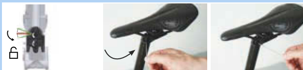
Rysunek 247: Ustawianie mechanizmu regulacji wysokości w pozycji „otwartej”
