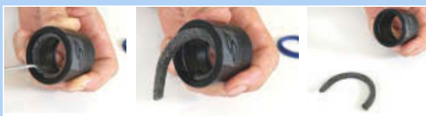
Rysunek 293: Wyciąganie pierścienia filcowego
