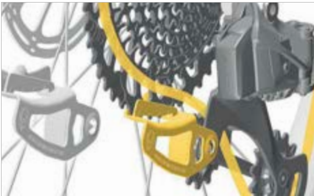
Rysunek 154: Łańcuch znajduje się na drugiej co do wielkości zębatce
