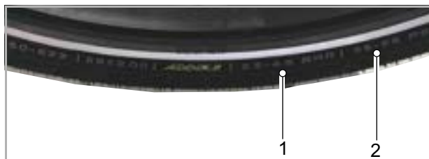
Rysunek 213: Dane ciśnienia w oponach w barach (1) i psi (2)
