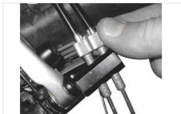
Rysunek 240: Wersje piast ROHLOFF z wewnętrznym sterowaniem zmiany biegów posiadają regulator naprężenia na wsporniku linek
