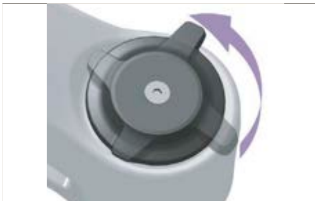
Rysunek 317: Wyregulować nastawnik dobicia tak, aby amortyzator był bardziej miękki
