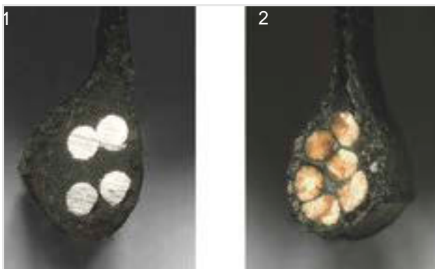
Rysunek 31: Rdzeń stalowy (1) i rdzeń kewlarowy (2)
