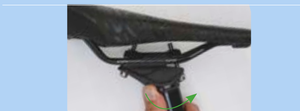
Rysunek 298: Otwieranie mechanizmu regulacji wysokości
