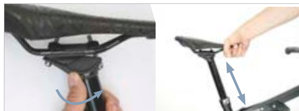
Rysunek 123: Regulacja wysokości sztycy podsiodłowej
