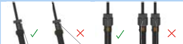
Rysunek 274: Prawidłowa i nieprawidłowa pozycja cięgna Bowdena
