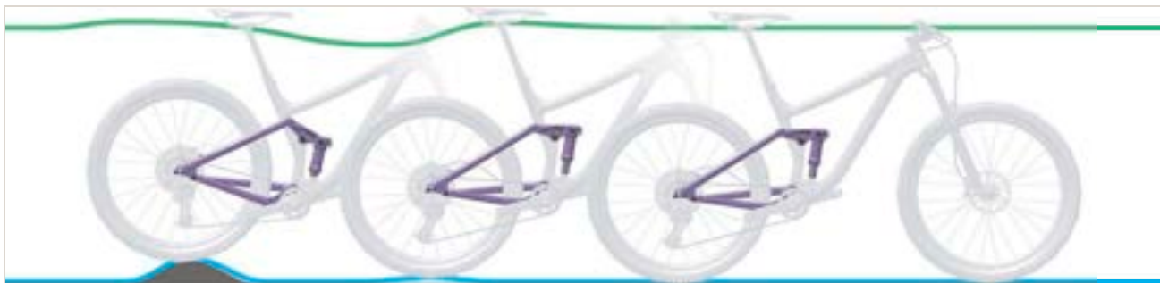
Rysunek 324: Zbyt szybkie rozprężanie się tylnego amortyzatora
