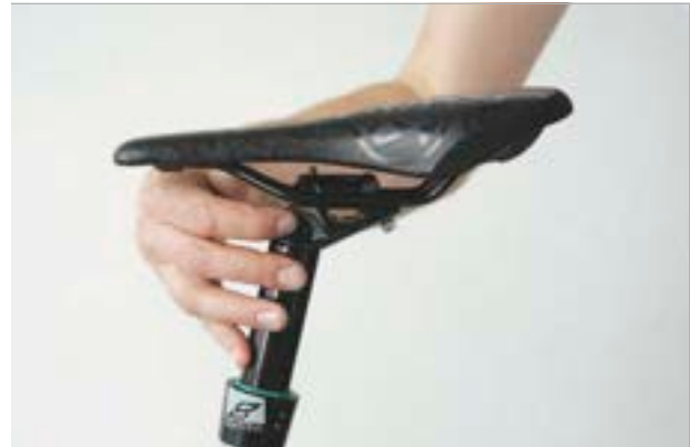
Rysunek 131: Ustawianie kąta siodełka na pokrętle regulacyjnym
