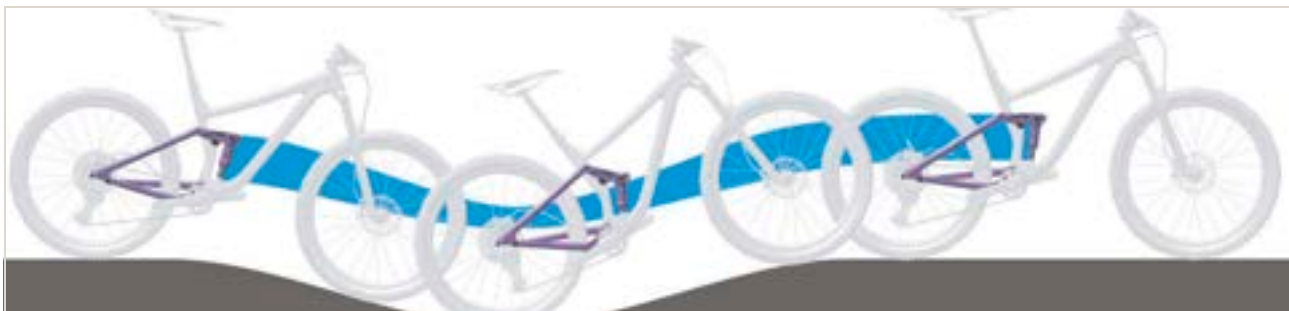
Rysunek 336: Zbyt miękkie amortyzowanie tylnego amortyzatora na wzniesieniu
