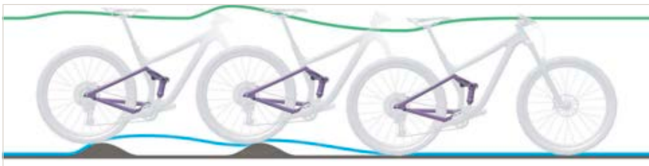
Rysunek 334: Zbyt wolne rozprężanie się tylnego amortyzatora
