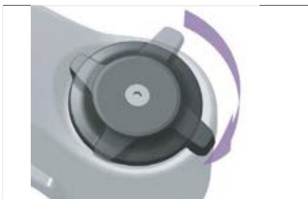
Rysunek 315: Wyregulować nastawnik dobicia tak, aby amortyzator był bardziej twardy
