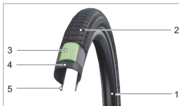
Rysunek 30: Budowa opony otwartej
