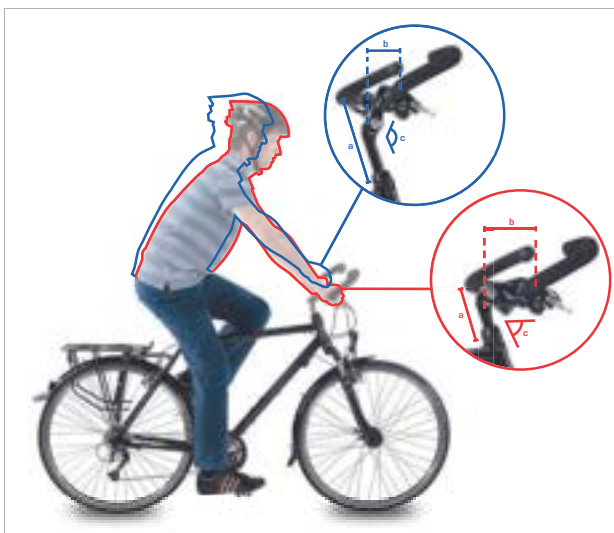
Rysunek 141: Pozycja roweru miejskiego (niebieski) i trekkingowego (czerwony) dzięki regulacji kąta nachylenia
