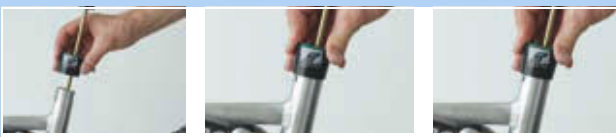
Rysunek 279: Nakładanie tulei zewnętrznej
