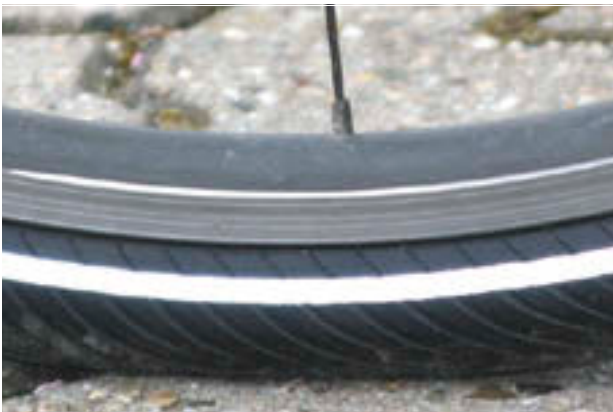
Rysunek 143: Prawidłowe ciśnienie w oponach. Opona prawie nie odkształca się pod wpływem masy ciała
