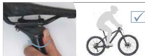
Rysunek 124: Dociąganie osi sztycy podsiodłowej
