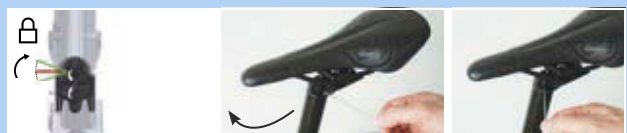
Rysunek 284: Zamykanie mechanizmu regulacji wysokości
