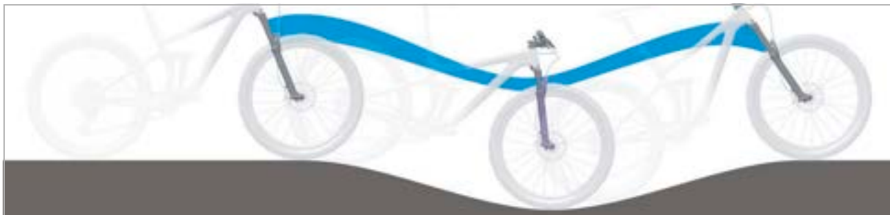
Rysunek 322: Zbyt miękkie amortyzowanie widelca na wzniesieniu
