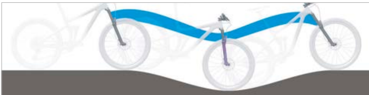
Rysunek 22: Optymalne działanie widełca amortyzowanego na pagórkowatym terenie
