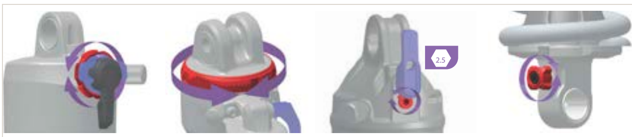
Rysunek 325: Pozycja i kształt nastawnika odbicia (tylnego amortyzatora) (kolor czerwony) zależy od modelu
