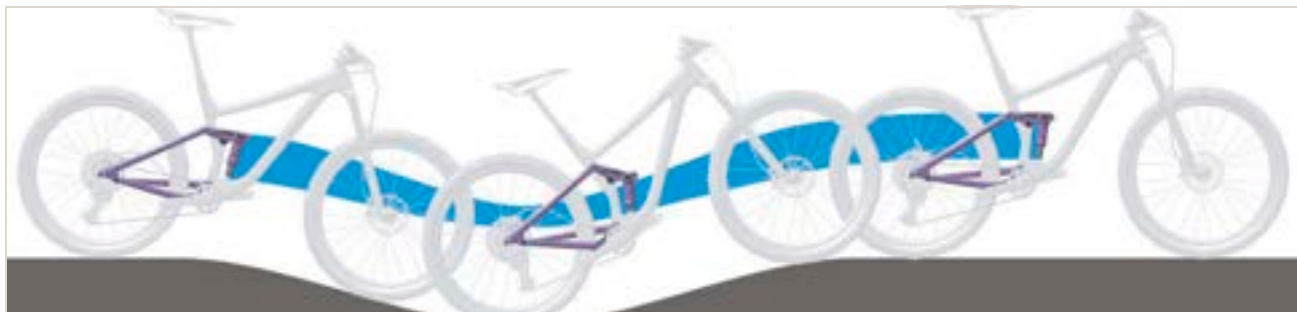
Rysunek 328: Zbyt miękkie amortyzowanie tylnego amortyzatora na wzniesieniu
