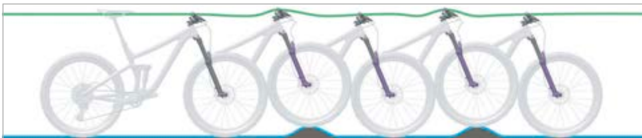
Rysunek 24: Optymalne działanie widełca amortyzowanego
