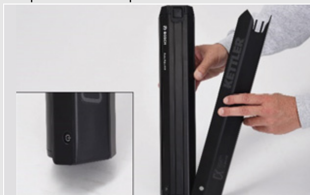
Figura 35: Applicazione della copertura della batteria sulla batteria
