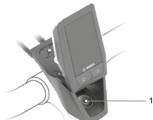
Figura 87: Ubicazione della vite della serie sterzo
