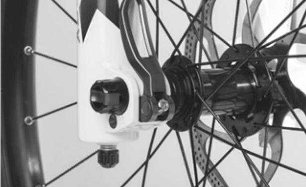
Figura 101: Regolazione della forza di serraggio del bloccaggio rapido
