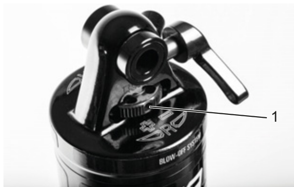
Figura 75: Regolatore del rebound Suntour (1) sull'ammortizzatore del carro posteriore
