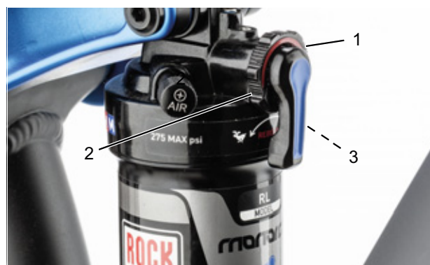
Figura 96: Regolazione della rigidità dell'ammortizzatore a stadi di trazione con la manopola di regolazione (1) dell'ammortizzatore del carro posteriore
