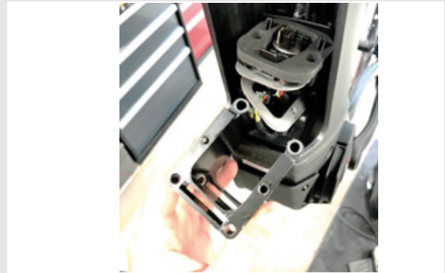
Figura 30: Estrazione dell'adattatore PowerTube
