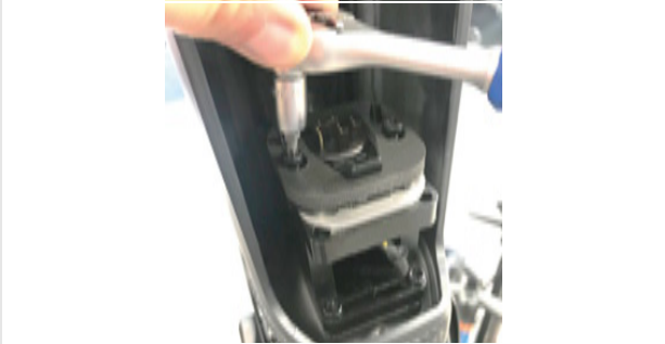
Figura 27: Svitamento delle viti del portabatteria
