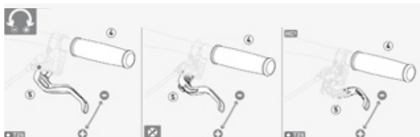
Figura 69: Regolazione dell'ampiezza di presa della leva del freno Magura con freno a disco
