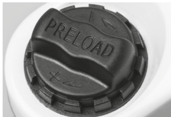
Figura 71: Manopola di regolazione dell'escursione negativa della sospensione sulla corona della forcella ammortizzata
