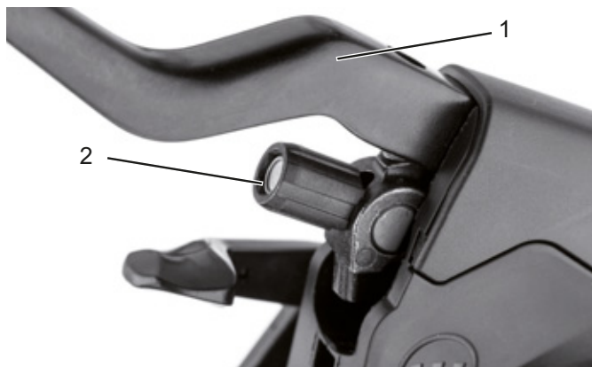
Obr. 73: Brzdová páka (1) hydraulicky ovládaných ráfkových brzd s nastavovacím šroubem (2)
