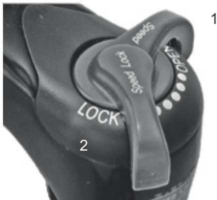
Obr. 55: Nastavovací šroub komprese Suntour s polohami OPEN (1) a LOCK (2)
